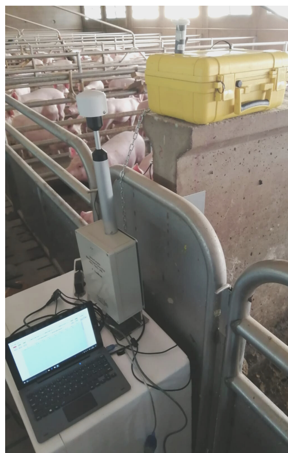
Fig 1. Strumenti per la misurazione del particolato in porcilaia
