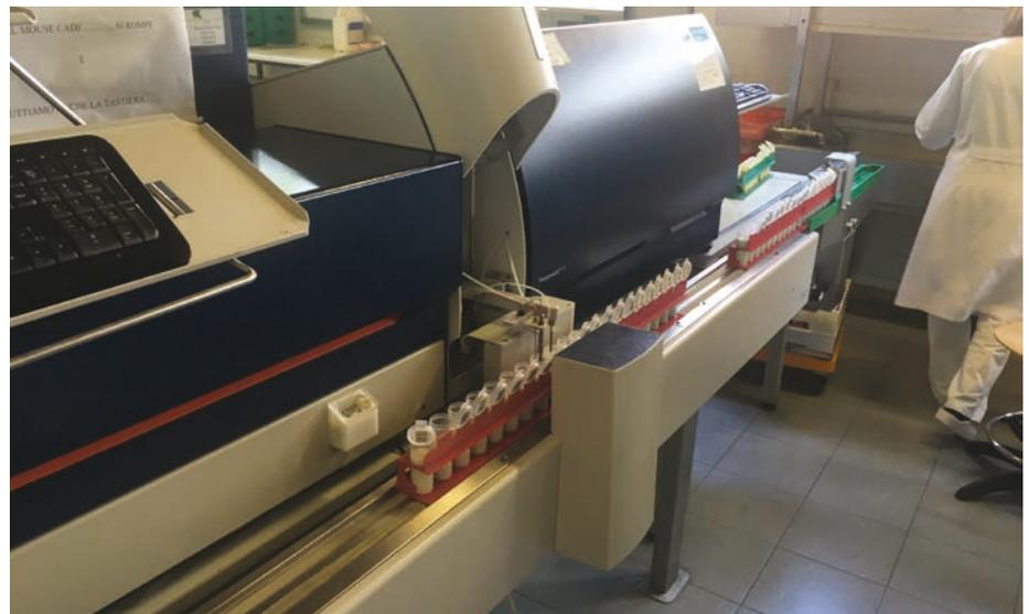
Figura 3 - La nuova linea Fossamatic DC 7 installata presso il laboratorio Aral di Crema in azione su campioni di latte.
