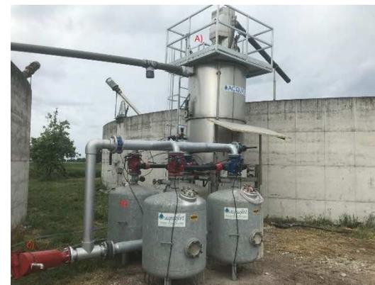
Permette di ottenere le forze interne vettoriali centrifughe necessarie per la spinta verso l'esterno del liquido e da un vaglio che trattiene la parte solida che viene espulsa nella parte superiore della macchina grazie ad una altra forza vettoriale acropeta. L'alimentazione viene effettuata nella parte inferiore e la pressione della pompa viene utilizzata per aumentare l'efficienza di separazione. La portata è di circa 4 m<sup>3</sup>/h di prodotto finito.
