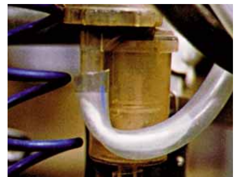
Foto 7 - Restringimento lungo l'impianto di mungitura
